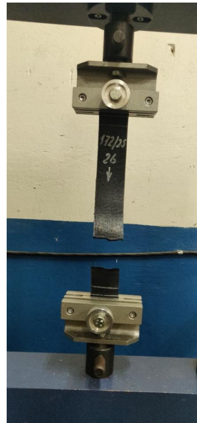
Рисунок 5 – Випробування на розривне навантаження бітумно-полімерного рулонного покрівельного та гідроізоляційного матеріалу а) 172/25-4 та б) 172/25-26
