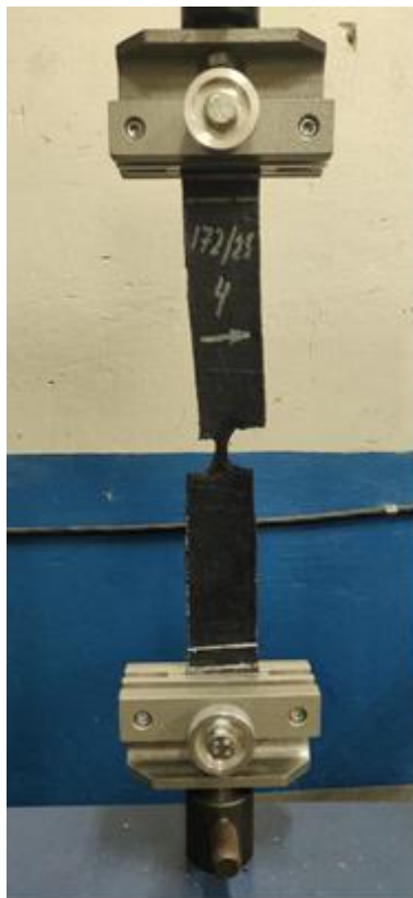
Рисунок 5 – Випробування на розривне навантаження бітумно-полімерного рулонного покрівельного та гідроізоляційного матеріалу а) 172/25-4 та б) 172/25-26
